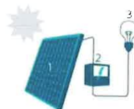
1. Zonnepaneel | 2. Omvormer | 3. Elektrische toestellen
