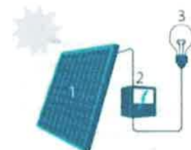
1. Zonnepaneel | 2. Omvormer 3. Elektrische meterkast
